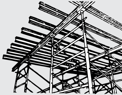
Las vigas de aluminio ALJ de BrandSafway se pueden usar como viguetas y como zancas.
